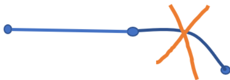
Figur 4. Linjegeometri med en cirkelbåge. Cirkelbåge är olämpligt att använda vid datautbyte.
