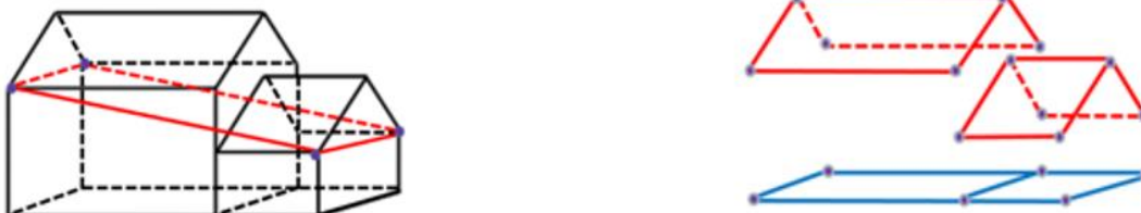
Figur 7.1.2b Två specialfall som inte följer LOD-begreppet enligt CityGML 2.0 men kan hanteras vid utbyte med Svensk geoprocess. Röd linje i vänstra bilden avser 3D-yta för "Lutande takkontur" och utbyts som LOD0 med särskilt värde för attributet höjdläge. Röd linje i den högra bilden avser 3D-ytor som "Fristående LOD2-tak" för utbyte av takkonstruktion i 3D utan väggar.
