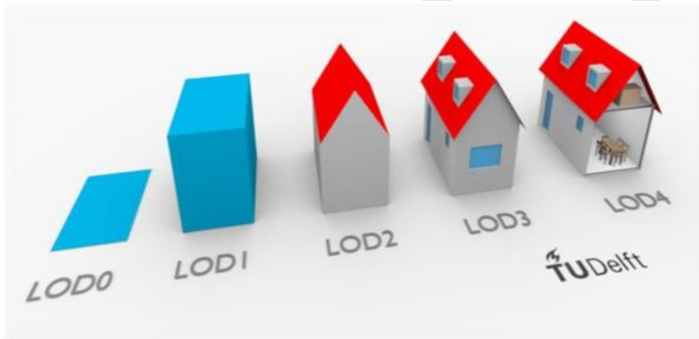
Figur 7.1.2a Schematisk bild av de olika LOD-nivåerna i CityGML 2.0. Svensk geoprocess hanterar inte LOD4. (Bild: Filip Biljecki, TUDelft)
