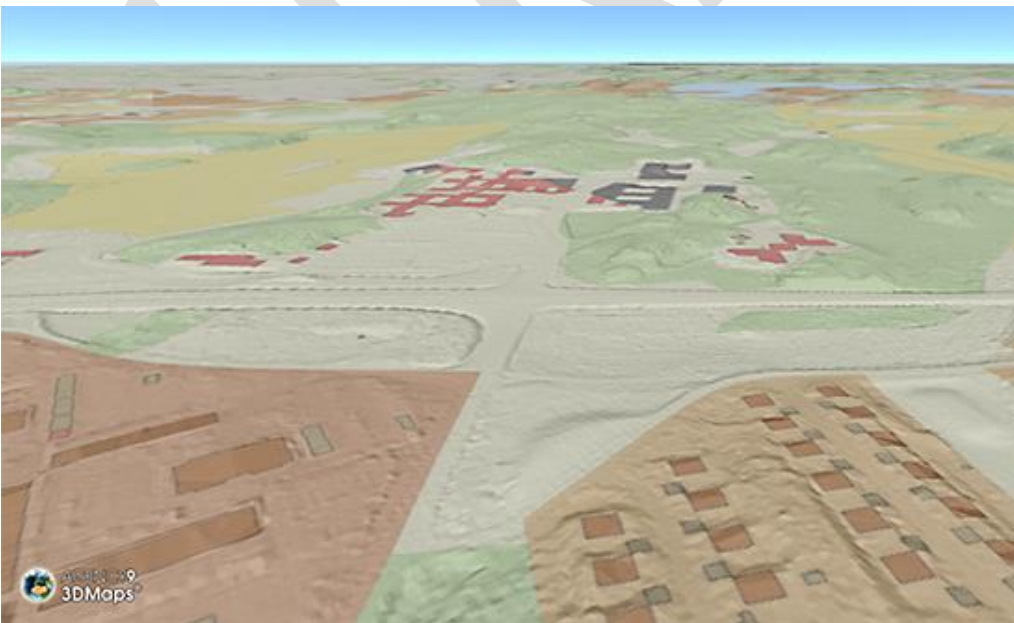
Figur 6.1.1a Den vänstra bilden visar en terrängskuggad markmodell (DTM), dvs en 3D-yta. Den högra bilden visar marktäcktet draperat på markmodellen. Uppstickande objekt/företeelser som byggnader och skog beskrivs i andra teman.
