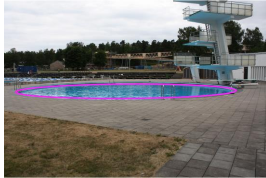
Figur 4.3e Exempel på plan- och höjdläge för simbassängkant. Om ytbildning och kodning av ytan önskas sätts centroid (avsnitt 6.1.2) och kod sätts till bassäng (nivå 4 av marktäcke, dvs vatten/stillastående vatten, anlagt stillastående vatten/bassäng). Koden bassängbad (nivå 3 av markanvändning, dvs rekreation/bad/bassängbad) kan användas för område med bassänger för bad eller simning samt andra markdetaljer som hopptorn, utedusch.
