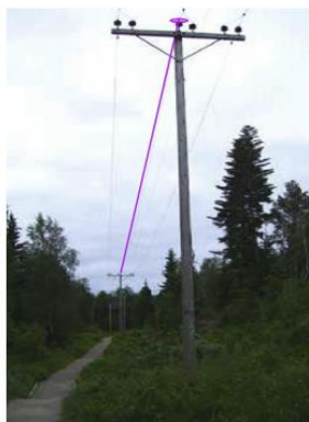
Figur 3.1c Exempel på kraftledning visualiserad genom långsgående och vertikala linjer. Den långsgående linjen konstrueras mellan redovisade brytpunkter och de vertikala linjerna konstrueras mellan brytpunkt och en markmodell, till exempel nationella höjdmodellen. Även 3D-symboler kan användas. Attributet variant kan användas för att exempelvis ange typ av luftledningsstolpe i
