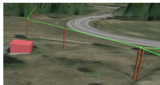
Figur 3.1c Exempel på kraftledning visualiserad genom långsgående och vertikala linjer. Den långsgående linjen konstrueras mellan redovisade brytpunkter och de vertikala linjerna konstrueras mellan brytpunkt och en markmodell, till exempel nationella höjdmodellen. Även 3D-symboler kan användas. Attributet variant kan användas för att exempelvis ange typ av luftledningsstolpe i
