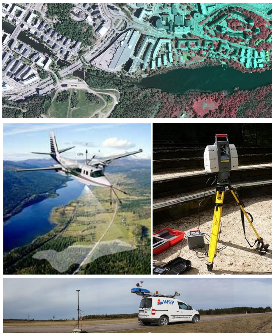
Figur 2.2. Ortofoto samt flygburen, terrester resp. fordonsburen laser-skanning. Foto: Lantmäteriet, Wikipedia, WSP.
