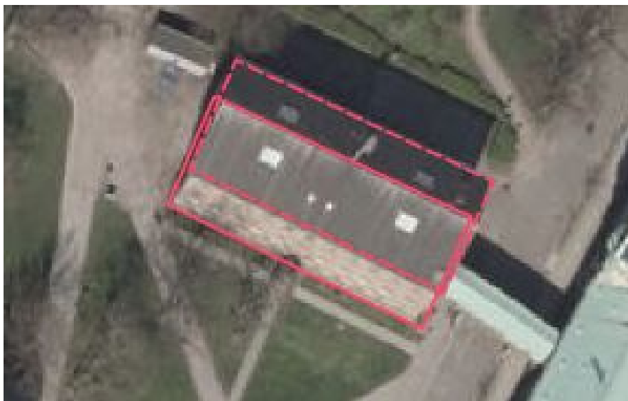
Figur 2.3.4. Exempel på deplacering. Den heldragna linjen avser husets verkliga läge. Den streckade avser hustaketets läge i ortofotot, dvs. deplaceringen.
