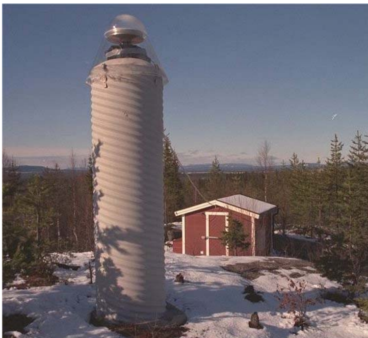
Figur 3: GPS-pelare med tillhörande instrumentbod
