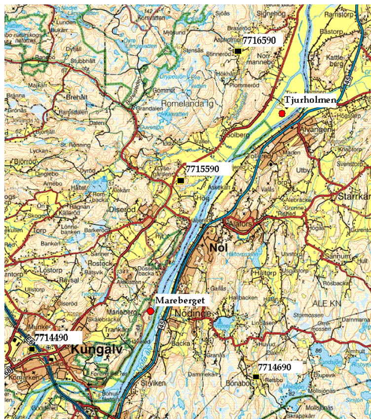
Figur 3. Testpunkter (svarta) och SWEPOS-stationer med lokal radioutsändning (röda). (Lantmäteriet, 2007 [bearbetad])
