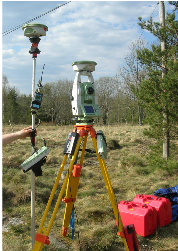
Figur 5. Utrustning för integrerad mätning med Leica SmartPole och totalstation.
