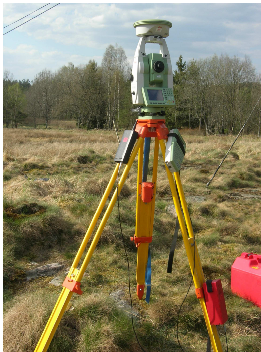
Figur 4. Utrustning för statisk GNSS-mätning med Leica SmartStation.
