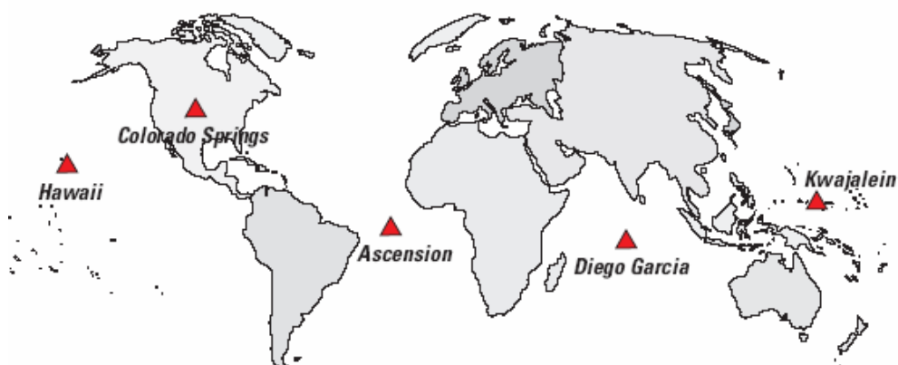
Figur 4.3: Övervakningssegmentet består av ett antal markbundna kontrollstationer (Leica geosystems 2003).
