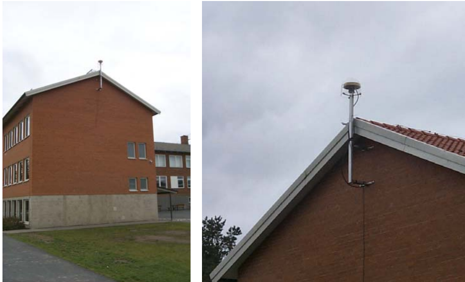
Figur 5: Stationen i Hillerstorp får illustrera placering av GPS-antennen på en förenklad SWEPOS-station.
