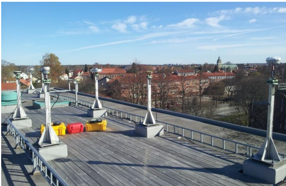
Figur 3: På Lantmäteriet i Gävle finns ett antennkalibreringsfält som användes för att genomföra studien.
