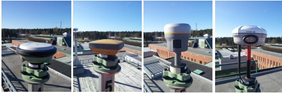
Figur 6: De fyra RTK-mottagarna uppsatta på antennkalibreringsfältet i ordningen Leica, Topcon, Trimble R10 och Trimble R8.
