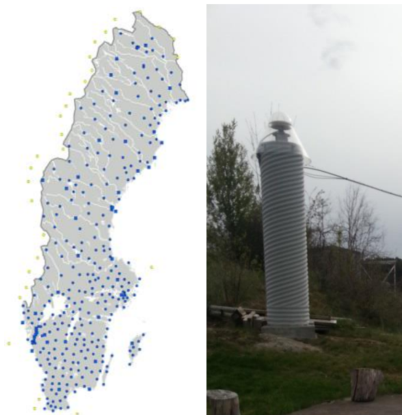
Figur 2: SWEPOS-nätets referensstationer (maj 2014) till vänster (Katrin, 2014). I södra Sverige är det förtätade nätet med ca 35 km mellan referensstationerna nästan färdigutbyggt. I norra Sverige är nätet glesare med ca 70 km mellan referensstationerna. SWEPOS-stationen i Uppsala till höger.
