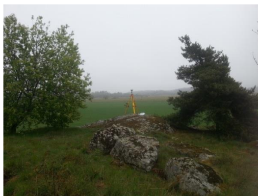
Figur 27: Hårby vid mätomgång tre. Två träd skymmer sikten mot himlen något i nordlig och sydlig riktning men antas inte ha någon avgörande betydelse för antalet tillgängliga satelliter.
