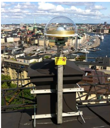
Figur 4 SWEPOS-stationen Mosebacke, en klass B-stationen vid Södra teatern på Södermalm i Stockholm. Till vänster antennen monterad på taket och till höger dataskåpet med tillhörande utrustning. Foto: SWEPOS Lantmäteriet.
