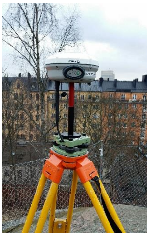
Figur 18 Rovern som användes i denna studie, Trimble R8-3.
