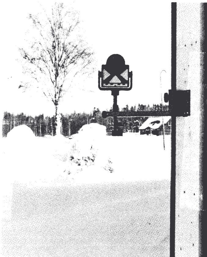
Figur 1: Markering i hushörn - hörnplatta, mätkonsol och prisma. (Foto: Torsten Oldenmark)
