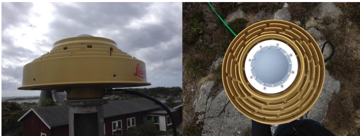
Antennen (LEIAR25) på OTT4-masten utan radom innan ändring (vänster och höger).
