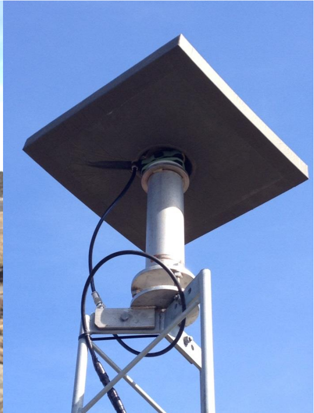
Toppen av antennfoten på OTT2 med ett tjockt isolerande skikt och en trefot installerad med en längre bult (vänster) och med antennen tillsammans med OSOS-radom, eccosorbkiva och extra antennkabel (höger).
