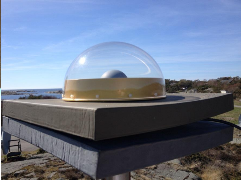
Installationen med en eccosorbskiva innan ändringen (vänster) och efter ändringen (höger) då två eccosorbskivor är installerade under antennen och antensladden sticker ut mellan skivorna.
