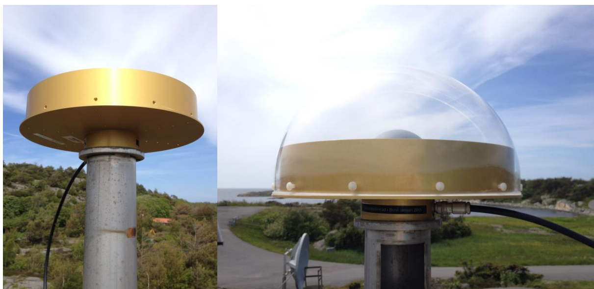
OTT2-antennen (Javadrिंगant-DM) utan radom innan ändring (vänster) och samma antenn med OSOS-radom efter ändring (höger).
