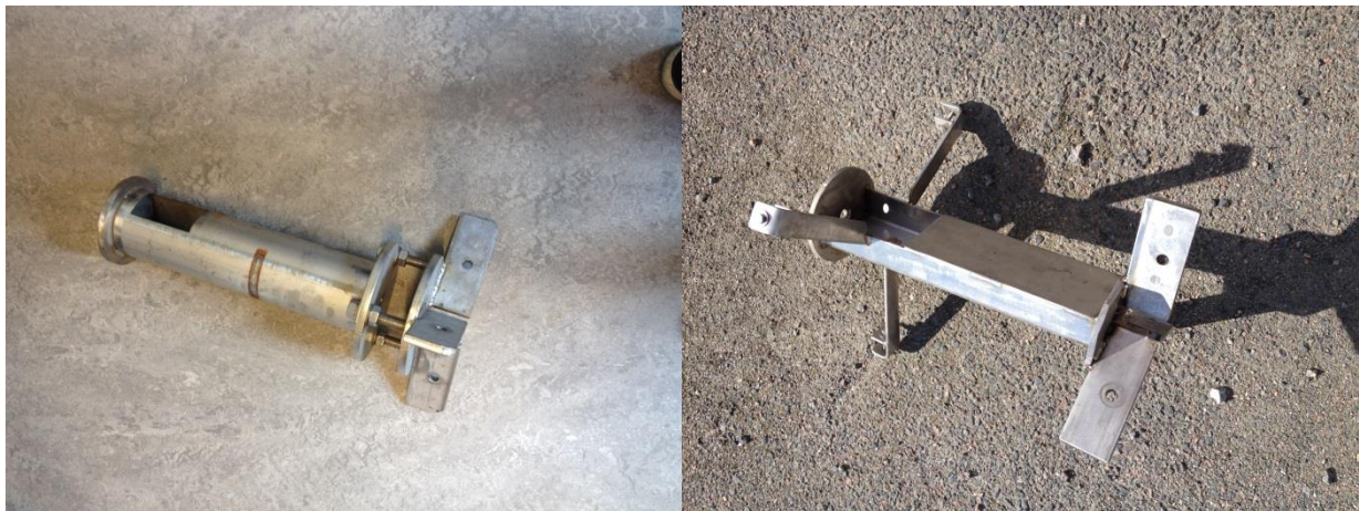
Den borttagna antennfoten med cirkulärt tvärsnitt (vänster) och den installerade antennfoten med rektangulärt tvärsnitt och 3st armar för att hålla fast en OSOD-radom (höger).
