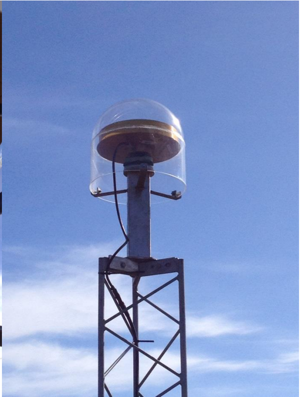
Antenninfästningen med trefot och isolerande skikt ovanpå den nyinstallerade antennfoten (vänster) och antennfoten på OTT4-masten med installerad OSOD-radom (höger).
