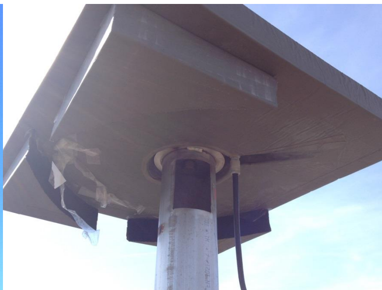
OTT2-masten med extra eccosorbbitar fastsatt under den befintliga eccosorbkivan direkt efter installation (vänster) och 5 dagar senare då två av de extra eccosorbbitarna har ramlat av (höger).
