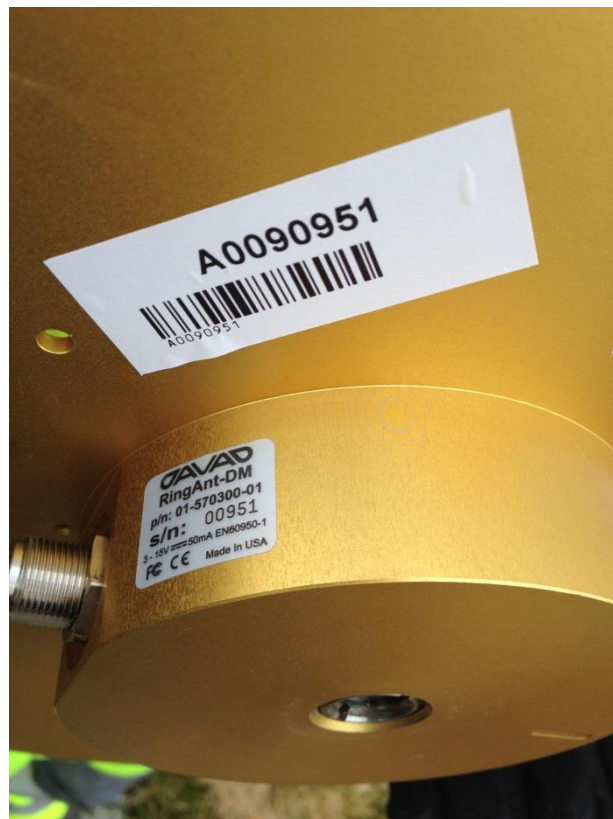
OTT2: installerad absolutkalibrerad antenn.
