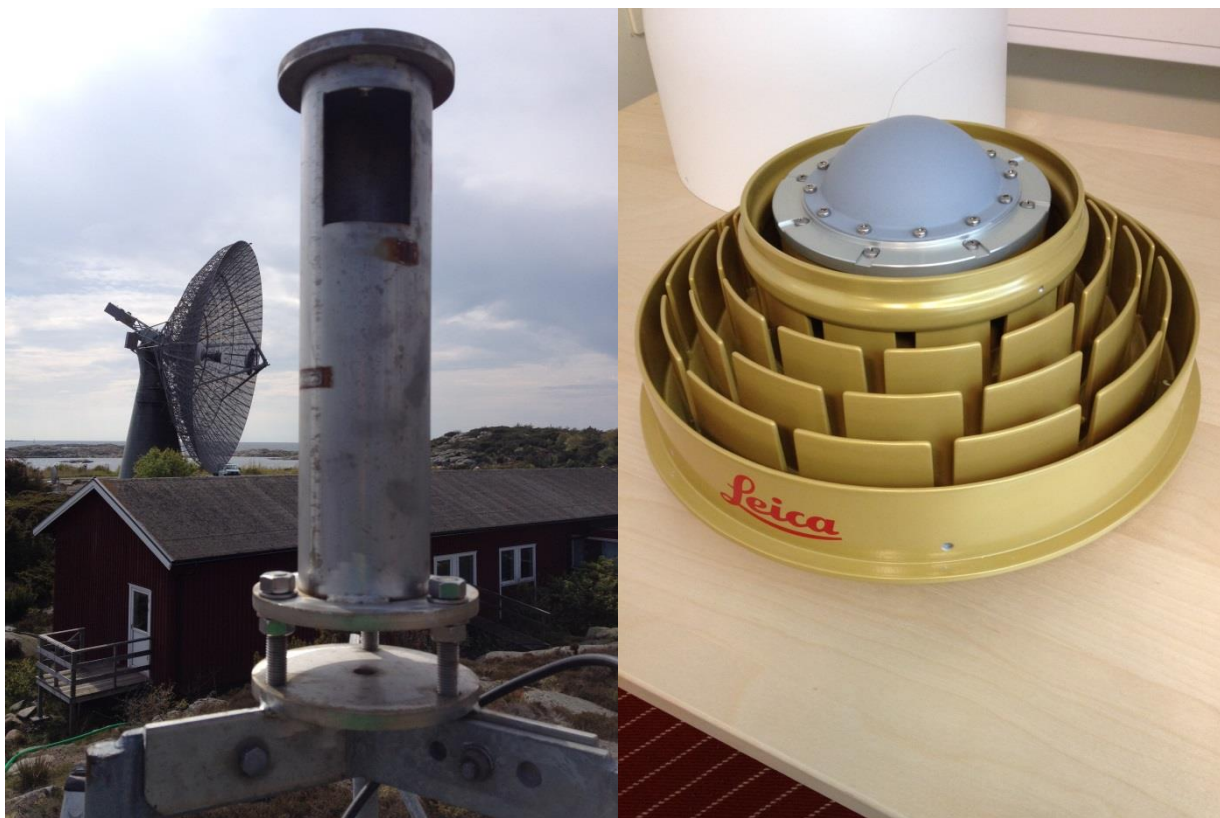
Den circulara antennfoten installeras åt samma håll som tidigare med toppen i våg (vänster). På antennfoten installeras därefter antennen LEIAR25.R3 (höger).
