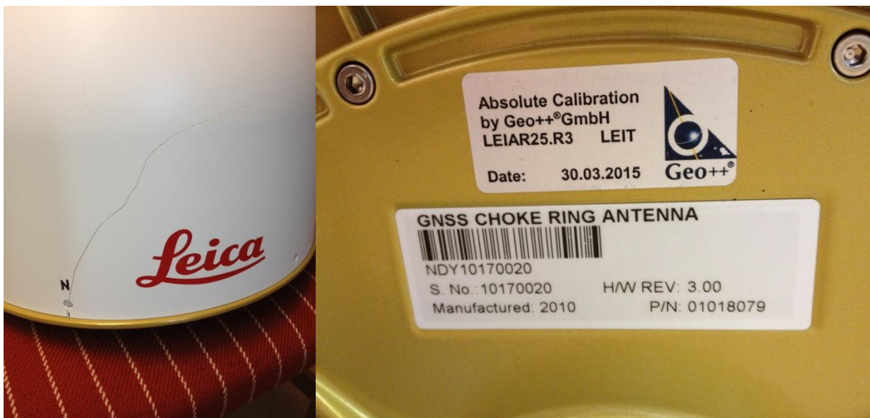
Den levererade dubbelkalibrerade antennen (absolutkalibrerad i kammare och med robot) LeiAR25.R3 med LEIT-radom (vänster och höger). Tyvärr har det blivit en spricka i radomen (antagligen under transporten) och de flesta plastskruvarna för att hålla fast radomen är sönder (antagligen vid installation av radomen).
