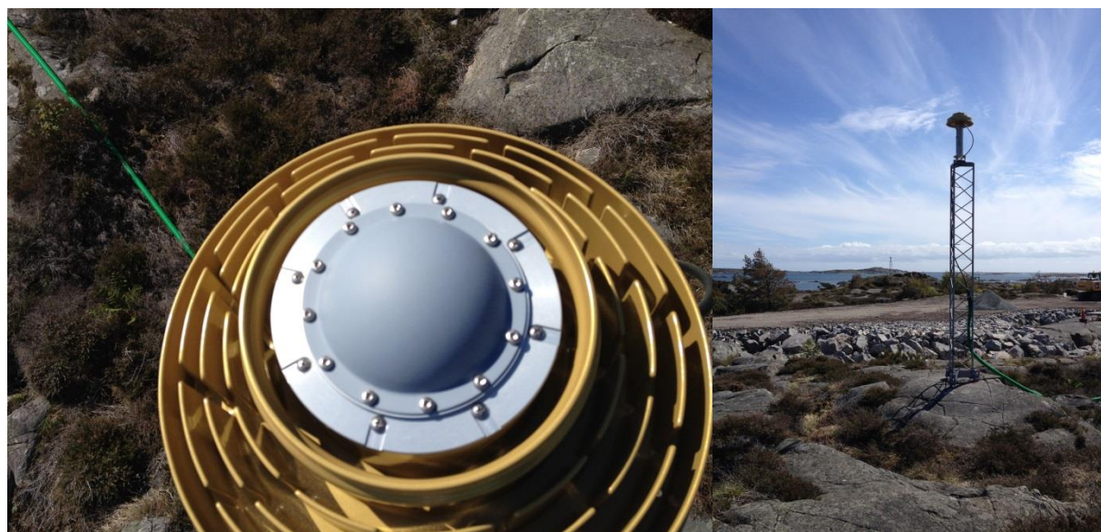
LEIAR25.R3-antennen utan radom visad uppifrån (vänster) och hela OTT4-masten mot söder (höger).
