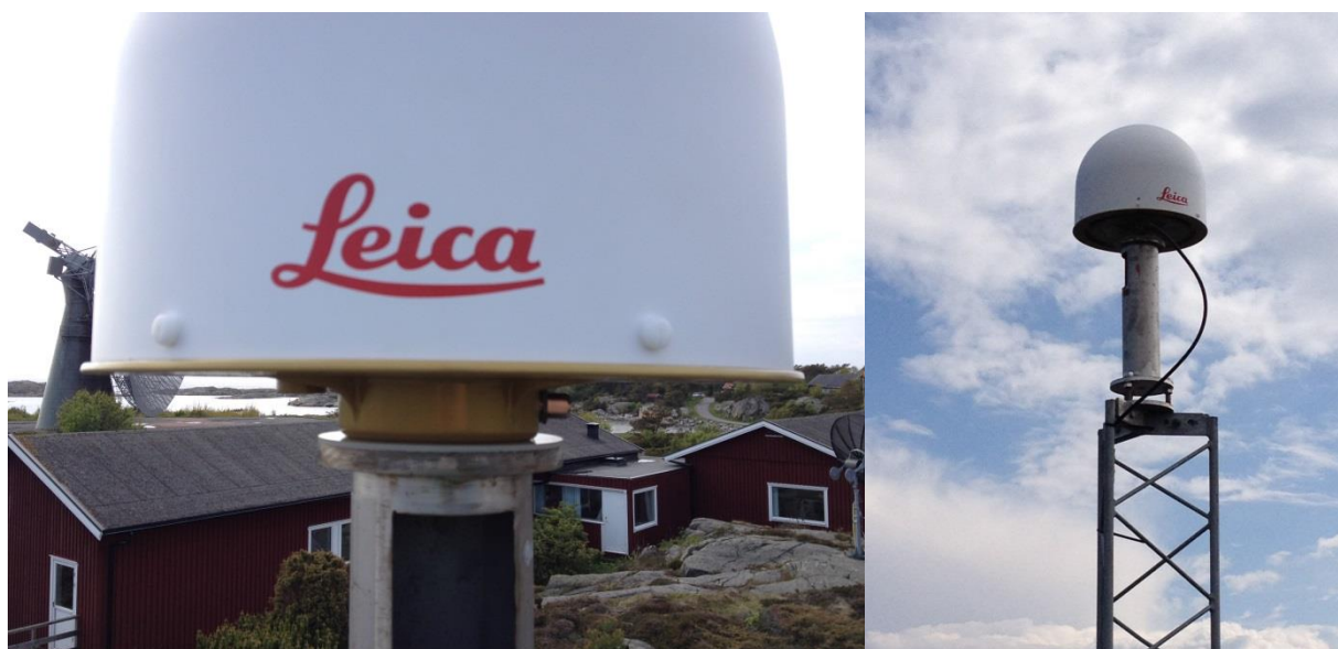
Den dubbelkalibrerade LEIAR25.R3 installeras med en LEIT-radom på OTT4-masten (höger och vänster).
