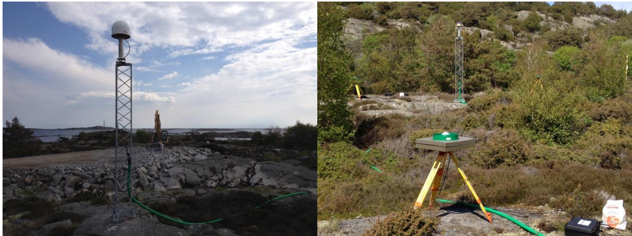
Arbetet med vägen mellan OTT4 och OTT6, har pågått under tisdag till fredag (vänster) och stationskalibreringsstationer med olika mycket eccosorb som installerades runt OTT1 i början av veckan (höger).
