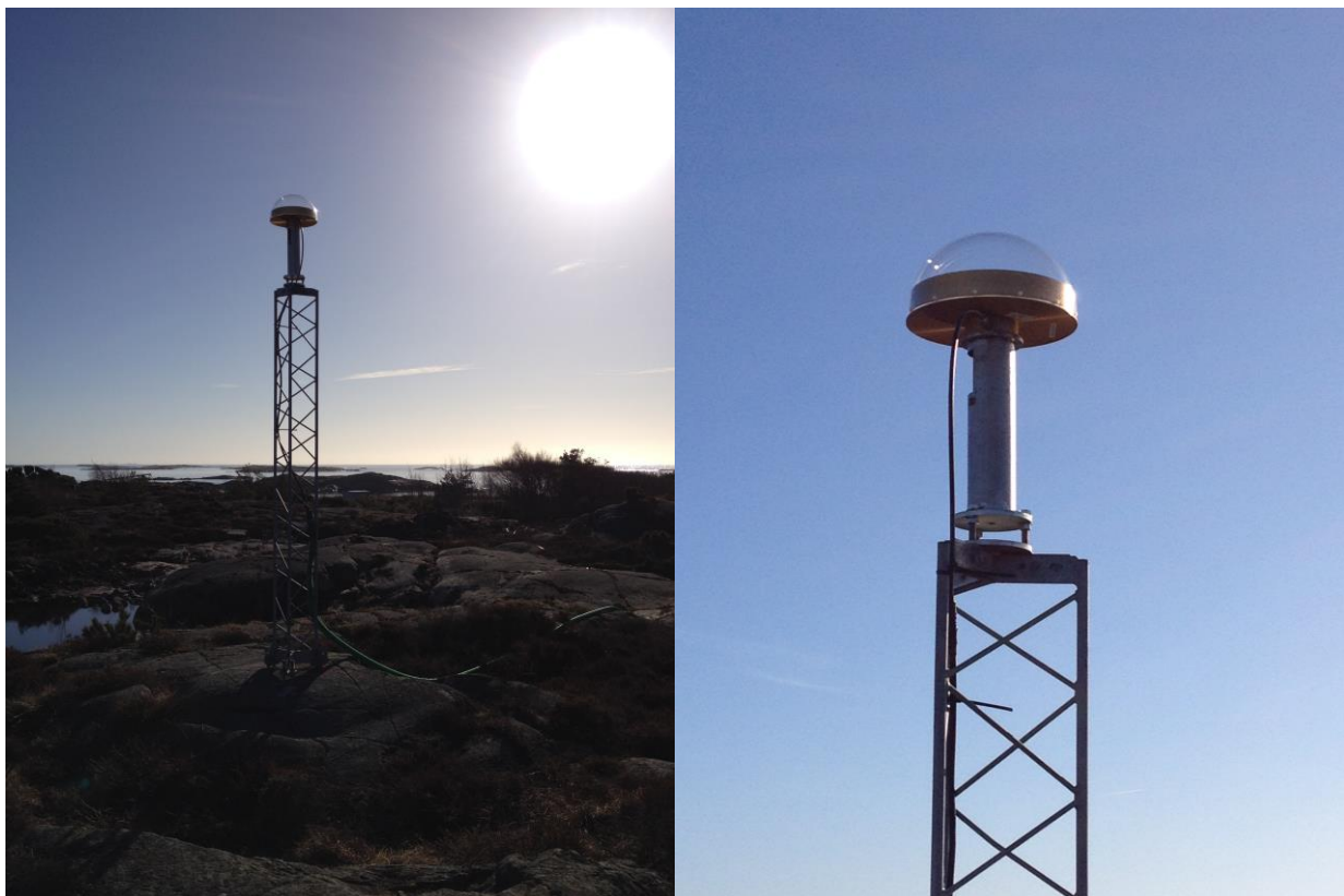
OTT4 med borttaget isolerande skikt (plastskira 3mm) mellan antenn och antennfot.
