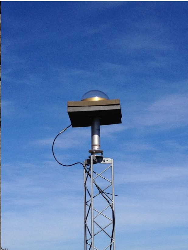
OTT2-antennen med 2st eccosorbskivor fotad uppifrån (vänster) och samma installation från sidan (höger).
