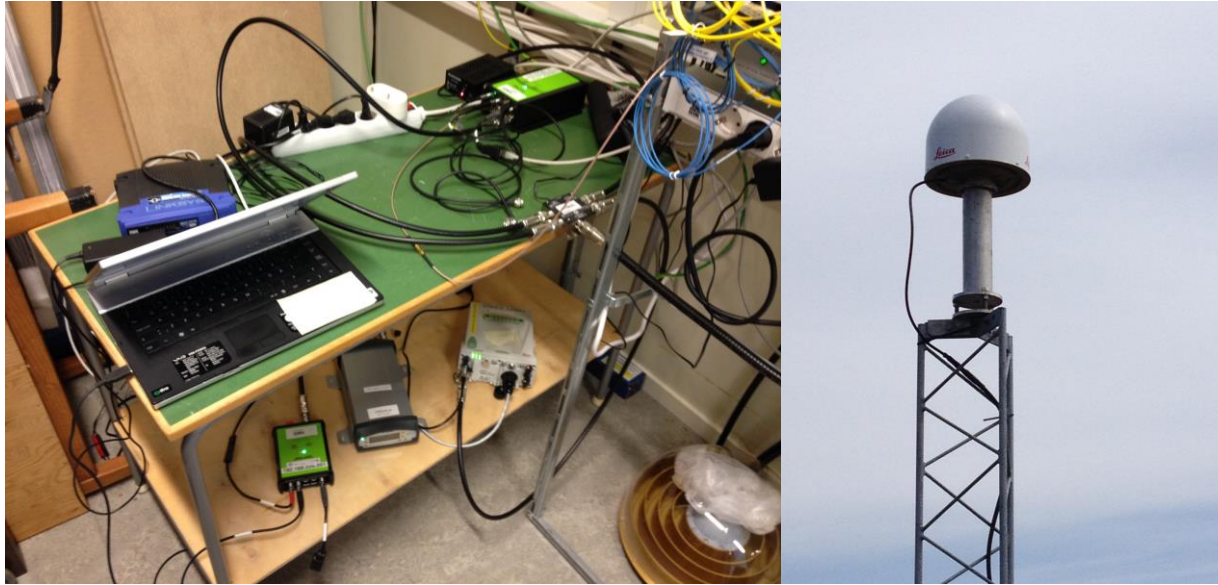
Hela uppställningen med 4 mottagare, en splitter och laptop (vänster) och OTT4-masten med antennen LEIAR25.R3 med LEIT-radom (höger).
