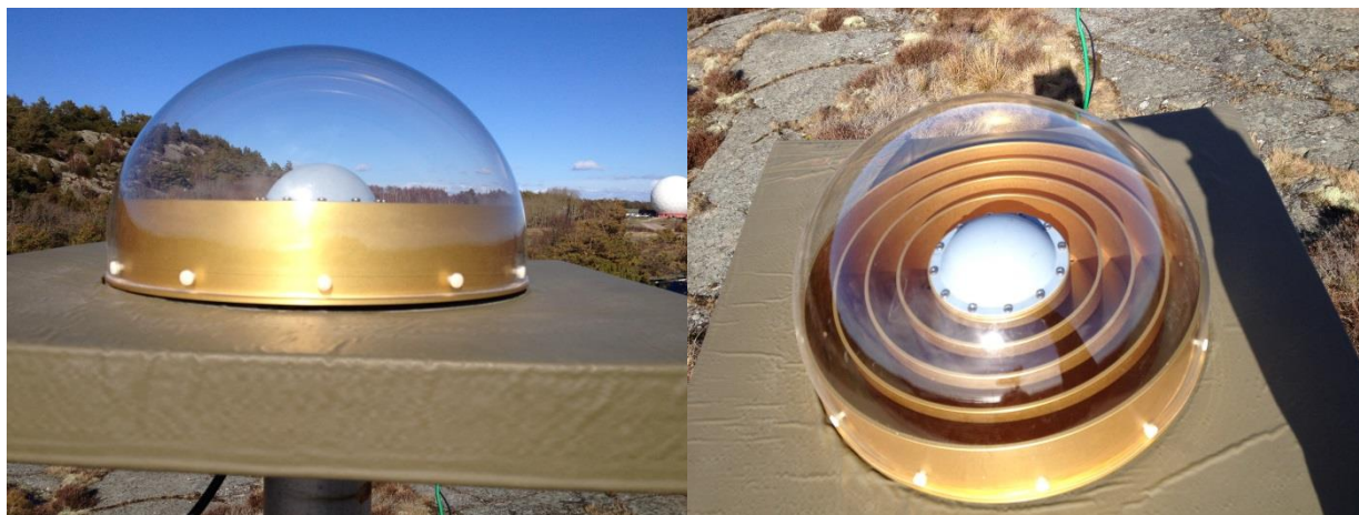
Absolutkalibrerad antenn med OSOS-radom och kvadratisk eccosorbskiva under choke-ringen.
