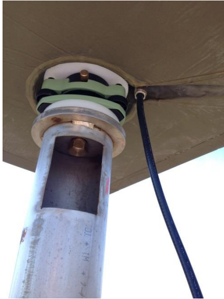
Installationen med en eccosorbskiva innan ändringen (vänster) och efter ändringen (höger) då två eccosorbskivor är installerade under antennen och antensladden sticker ut mellan skivorna.
