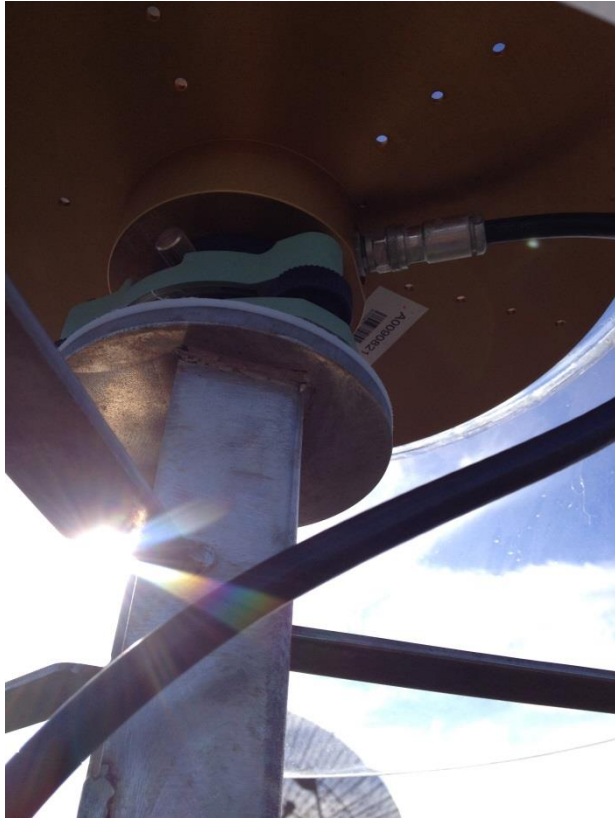
Antenninfästningen med trefot och isolerande skikt ovanpå den nyinstallerade antennfoten (vänster) och antennfoten på OTT4-masten med installerad OSOD-radom (höger).
