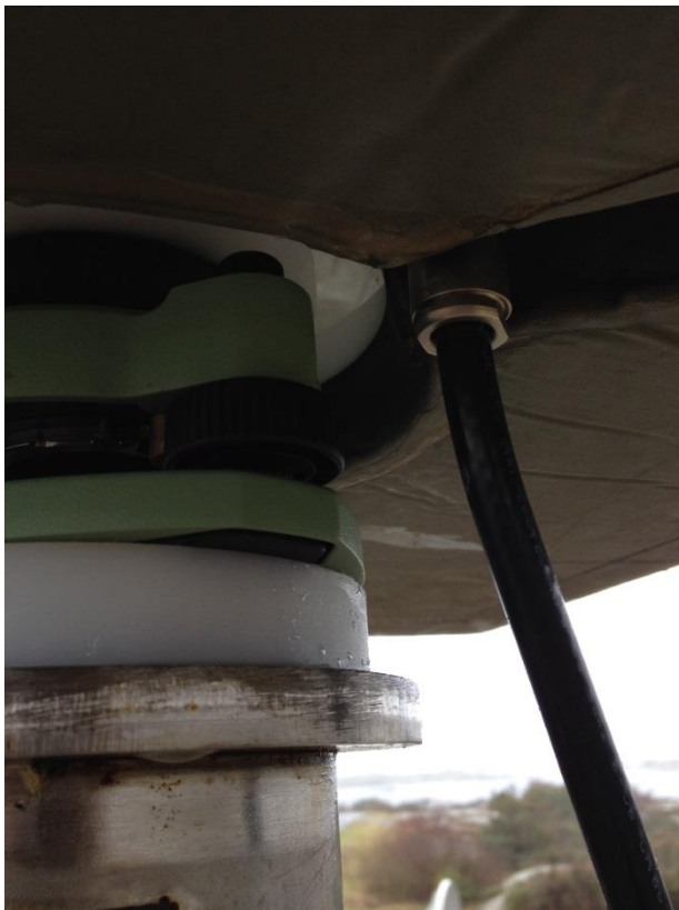
Den nya installationen med tjockt isolerande skikt, trefot med adapter, tunt isolerande skikt och antenn med OSOS-radom och eccosorbskiva (vänster) och samma installation uppifrån (höger).
