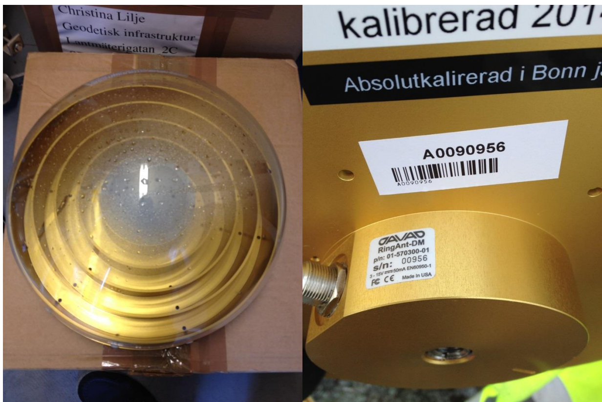
OTT6: borttagen okalibrerad antenn (vänster) och installerad absolutkalibrerad antenn (höger).
