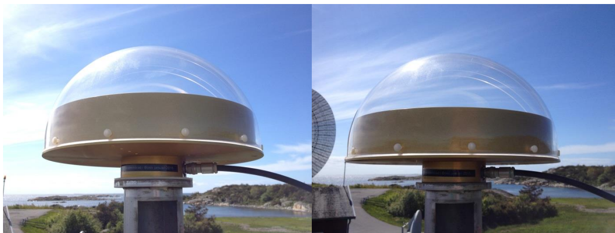
Den dubbelkalibrerade Javadrिंगant-DM med OSOS-radom på OTT2-masten med ett isolerande skikt mellan antenn och antennfot innan ändringen (vänster) och utan isolerande skikt efter ändringen (höger).
