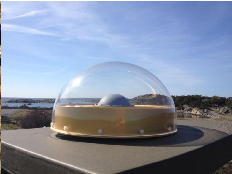
Infästningen av den extra antennsladden (vänster) och antennen med OSOS-radom och eccosorbkiva (höger).
