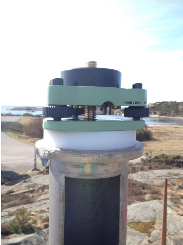
Toppen av antennfoten på OTT2 med ett tjockt isolerande skikt och en trefot installerad med en längre bult (vänster) och med antennen tillsammans med OSOS-radom, eccosorbkiva och extra antennkabel (höger).
