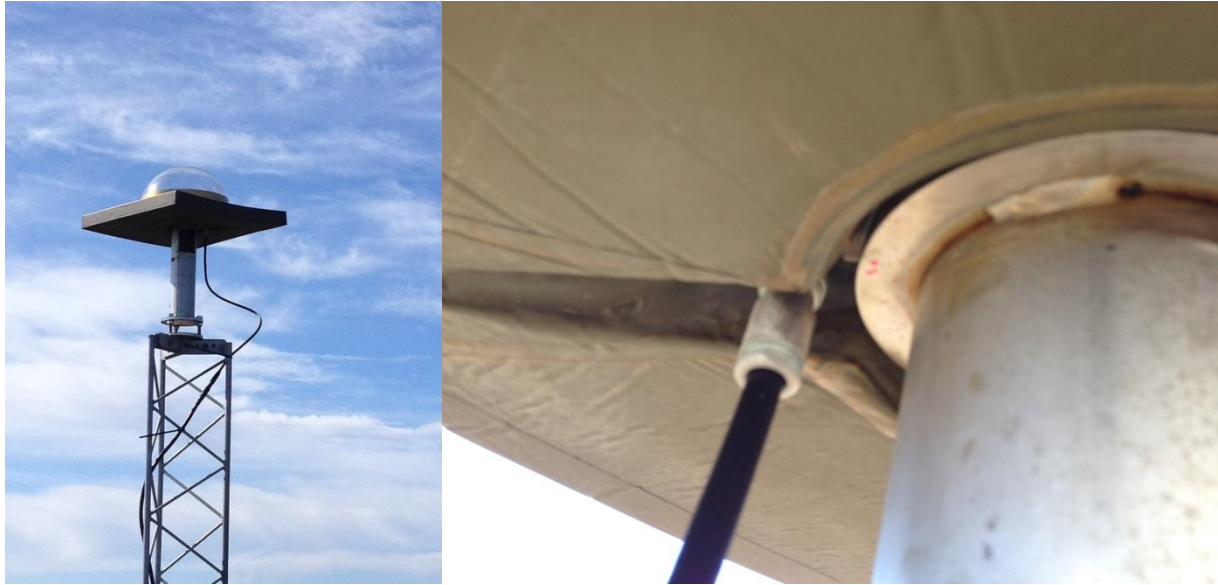
OTT2-masten med kvadratisk eccosorbskiva under antennen (vänster) och bild på antensladdsfästningen (adapter med 90-graders vinkel) vid undersidan av eccosorbskivan (höger).
