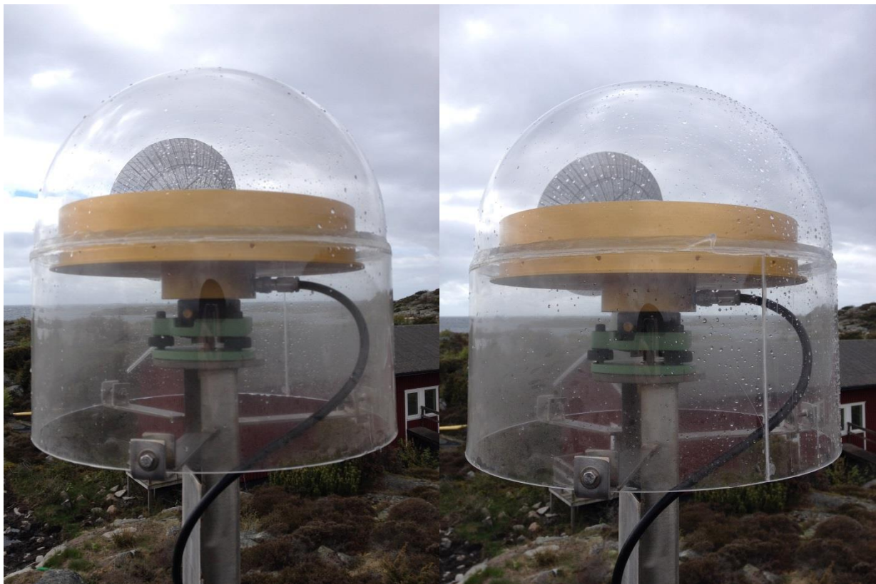
OTT4-masten innan ändringen (vänster) och OTT4-masten efter att OSOD-radomen har lossats, vridits ett tredjedels varv i klockans riktning till ursprungspositionen och därefter sats fast (höger).
