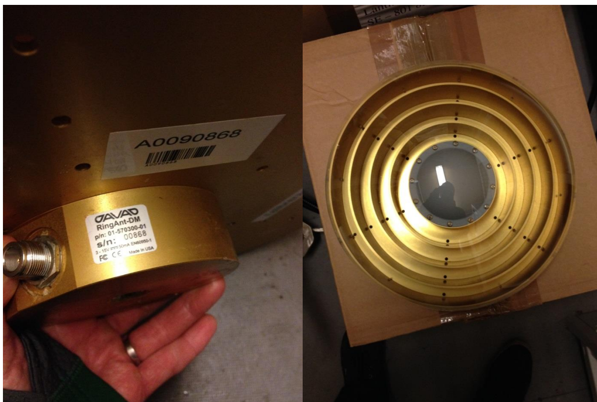
OTT1: borttagen okalibrerad antenn (vänster) och installerad absolutkalibrerad antenn (höger).
