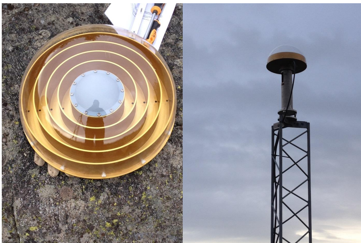
OTT4: okalibrerad antenn med OSOS-radom påskruvad enligt Lantmäteriets anvisning.
