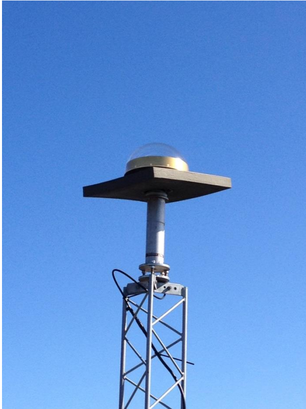
OTT2-masten innan ändringen (vänster), då eccosorbskivan sitter snett och antennen har ändrat azimutriktning, och installation av ett tunt isolerande skikt direkt under antennen (höger) för att hålla fast eccosorbskivan på ett bättre sätt.
