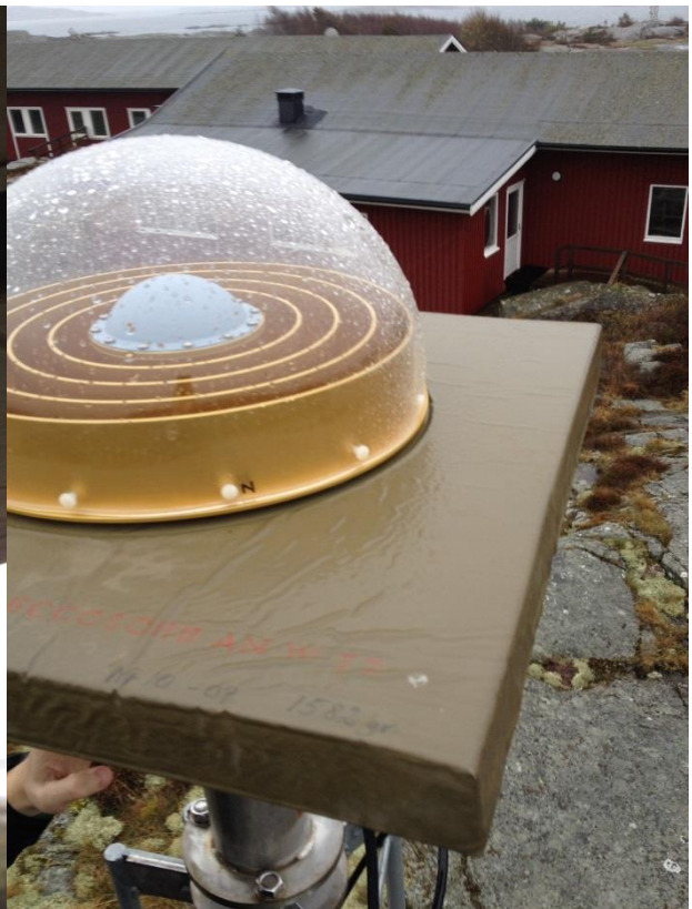
Den nya installationen med tjockt isolerande skikt, trefot med adapter, tunt isolerande skikt och antenn med OSOS-radom och eccosorbskiva (vänster) och samma installation uppifrån (höger).
