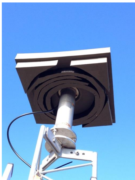
OTT2-masten med extra eccosorbbitar fastsatt under den befintliga eccosorbkivan direkt efter installation (vänster) och 5 dagar senare då två av de extra eccosorbbitarna har ramlat av (höger).
