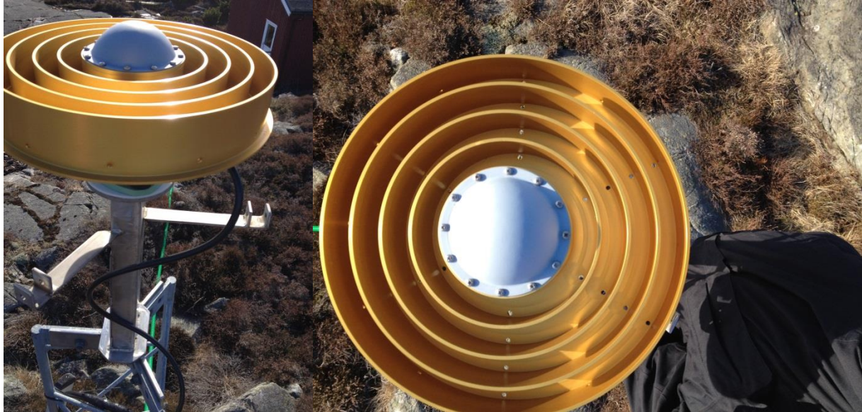
OSOD-radomen monteras av från antennfoten på OTT4 utan att riktningen av antennen ändras.
