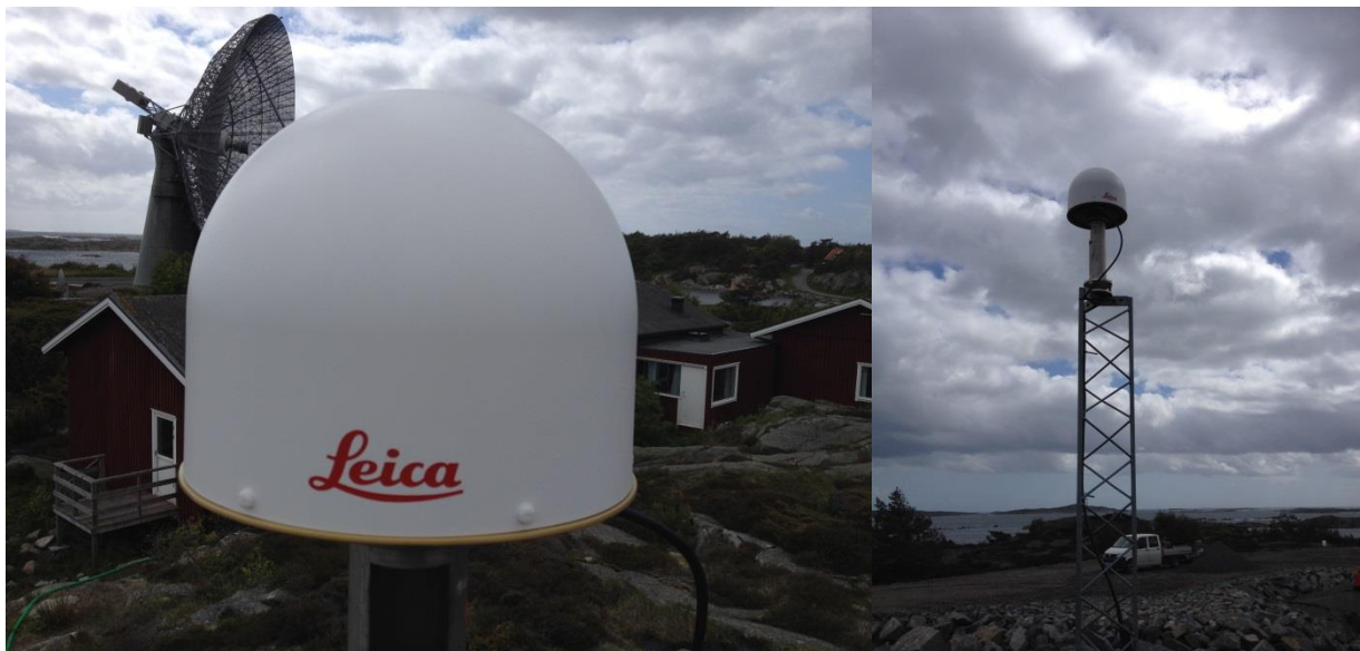
Antennen (LEIAR25) med LEIT-radom efter ändring (vänster och höger).
