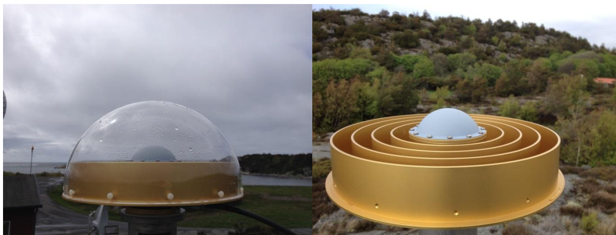
Den dubbelkalibrerade (absolutkalibrerad i kammare och med robot) Javadringant-DM-antennen med OSOD-radom innan ändring (vänster) och utan radom efter ändring (höger).
