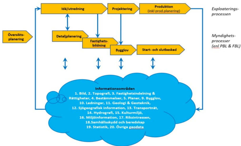
Figur 2. Översiktlig samhällsbyggnadsprocess enligt Smart planering för byggande 6 . I molnet framgår de preliminära informationsområden som konsumenter i både exploaterings- och myndighetsprocessen önskar enkel tillgång till. För varje informationsområde kan det finnas en eller flera producenter av geodata, på nationell, regional och lokal nivå.
